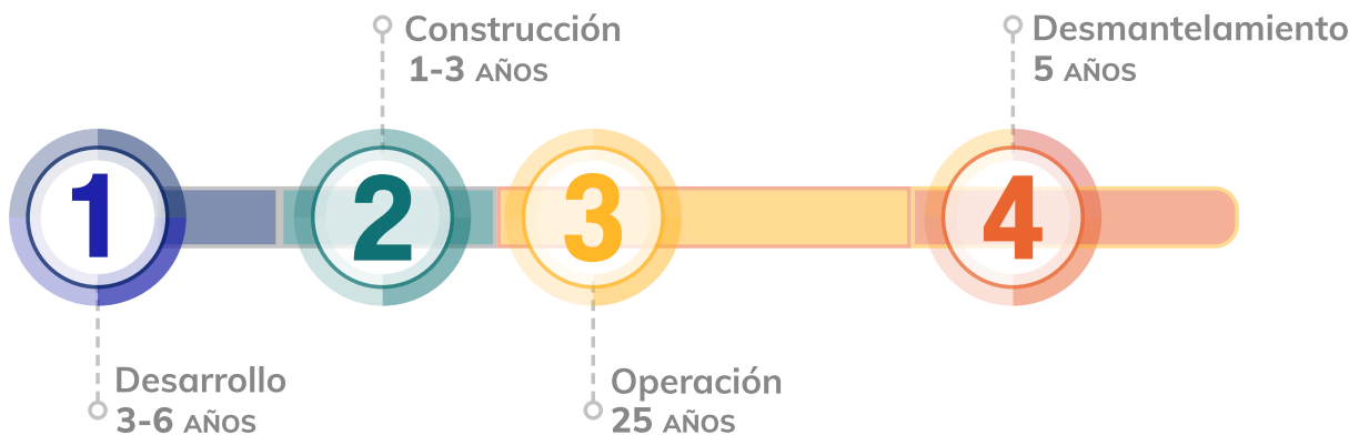
Diagrama de las etapas de un proyecto solar fotovoltaico de gran escala
